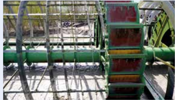
Sandschöpfräder, in denen sich langsam drehende Schneckenspiralen den in der Schöpfradwanne abgesetzten Feinsand Richtung Schöpfrad wieder zurückführen, dienen in vielen Kieswerken der Gewinnung von Feinsand 0/1 mm, Foto: BGR.
