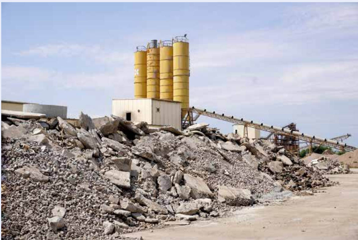
Größtenteils nur sortenreiner Altbeton ist für die Herstellung von zertifizierbarem RC-Material für die Produktion von R-Beton geeignet, Foto: BGR.
