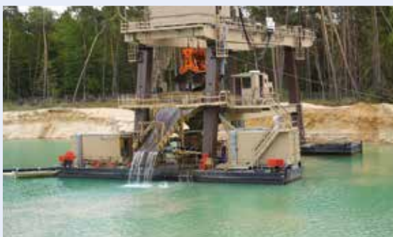
Auch aus sehr großen Wassertiefen können Schwimgreifer große Mengen auch grobkörniger Kiessande gewinnen. Moderne, sehr große Schwimgreiferanlagen kosten über 4 Mio. €, Foto: BGR.
