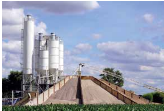
Die Kiessorte 2/8 mm gewaschen ist unverzichtbar für die Herstellung von Transportbeton. Hier das Transportbetonwerk Leubingen der Dyckerhoff GmbH in Thüringen, in dem die verschiedenen Gesteinskörnungen statt wie zumeist in Silos gut sichtbar in einer offenen Sternanlage gelagert werden, Foto: BGR.
