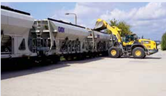
Über 15 Kieswerke in Deutschland verfügen über die Möglichkeit einer Bahnverladung. Hierbei werden die Waggons entweder automatisch, oder, wie hier im Kieswerk Laußig in Sachsen, mit Radlader beladen, Foto: BGR.
