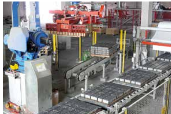
In der Produktion von Betonpflastersteinen kommen auch zahlreiche Sondersorten zum Einsatz, hier Betonpflastersteinproduktion im Werk Rheinau-Freistett der Hermann Peter KG, Foto: BGR.
