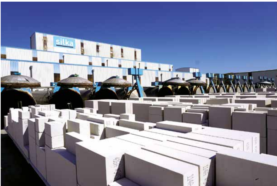
Vor den geöffneten Dampfdruckkesseln, den Autoklaven, kühlen die gehärteten Kalksandsteine ab und warten auf ihre Verladung, Foto: BGR.
